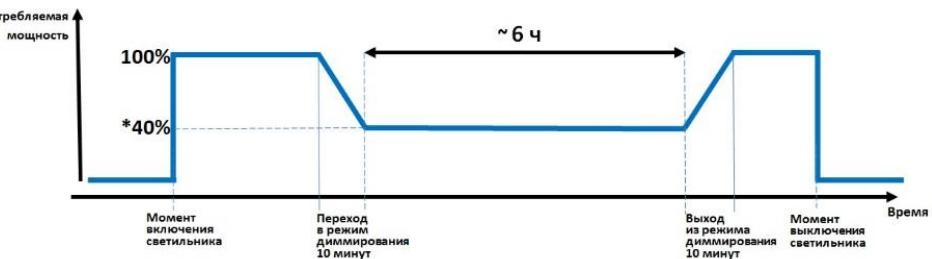
Рисунок 2 – Принцип работы функции автодиммирования
