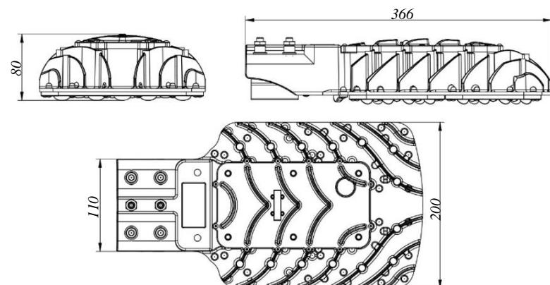
Рисунок 1 – Общий вид и габаритные размеры светильника
